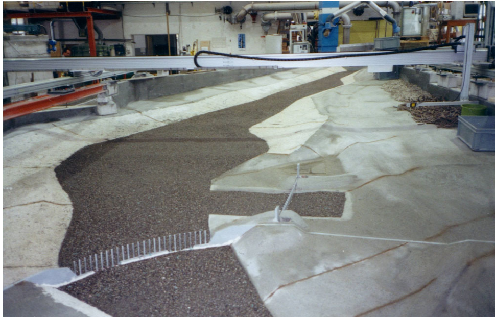
Abb. 4 Versuchsaufbau zur Simulation des Hochwasserabflusses
