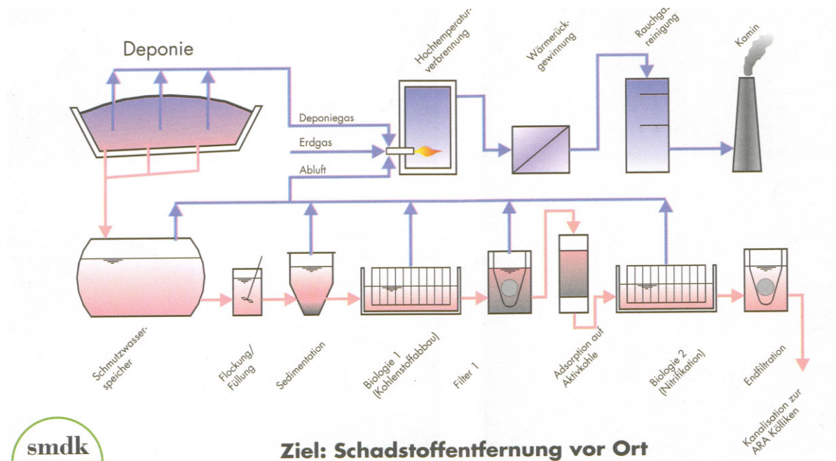
Abb. 9 Verfahrensschema der SWALBA- Anlage (aus: „Sondermülldeponie Kölliken“)
